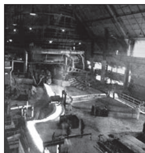
119. Spust surówki z wielkiego pieca
