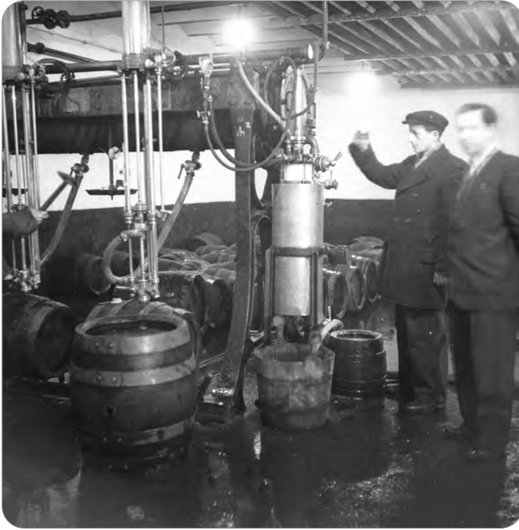
Ryc. 26 – rozlew piwa do beczek za pomocą aparatu izobarycznego. Browar w Polczynie-Zdroju, koniec lat czterdziestych.
