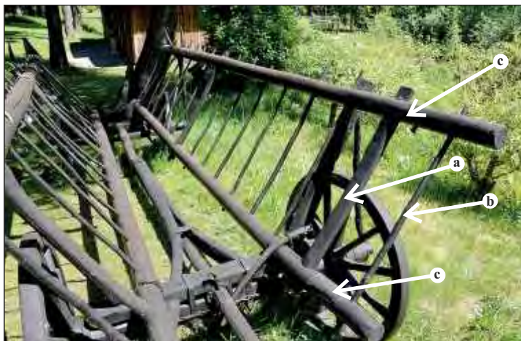
Lytra 1 – CzG, Dr, Fr, Fs, Jw, Kc, ŁN, Łp, ŁW, Nd, Rp, Tr [ drabina – Fr, Fs, Kc, Tr; grabina – Jw]; fot. JK; ze zbiorów MSidz a – syda – Fr, Kc, Nd [ desecka – Jw; syba – CzG, Fr, Rp; śmigla – Fr] b – scebel – Fr, Nd [ dronzek – Jw; patyk – Fr] c – drong – CzG, Fr, Fs, Jw, Łp, ŁW, Nd, Tr [ dronzek – Jw; palica – ŁW, Nd]
