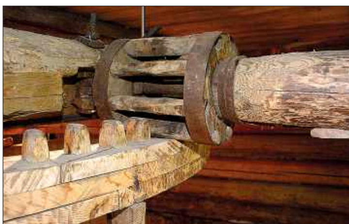
Cewi w drewnianym kieracie – CzG, Łp, Rp, Tr [cewie – Fs, Kr, Nd; cewy – Kc, ŁN; csewie – Fr]; fot. JK; ze zbiorów MT-CzG
