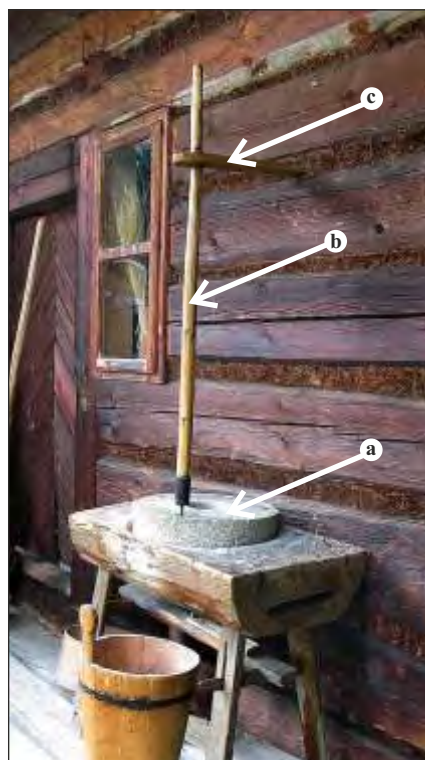
Biegun 1 w żarnach – Fr fot. JK; ze zbiorów PE-ZG a – biegun b – miyłok – Fr [łoska – Tr] c – powółka – ŁN, Tr
