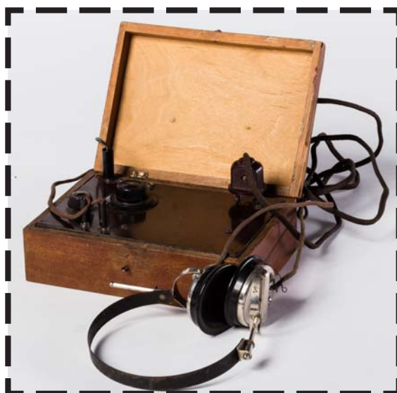
Lampowy aparat radiowy na słuchawki wykonany konspiracyjnie z części produkowanych w Generalnym Gubernatorstwie [zbiory Muzeum Regionalnego w Pińczowie]
